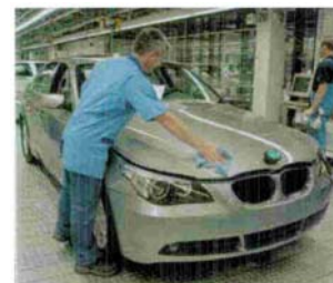
OPERAI ALLA LUCIDATURA FINALE DI UN MODELLO DELLA BMW DOPO IL PASSAGGIO ALLA VERNICIATURA
